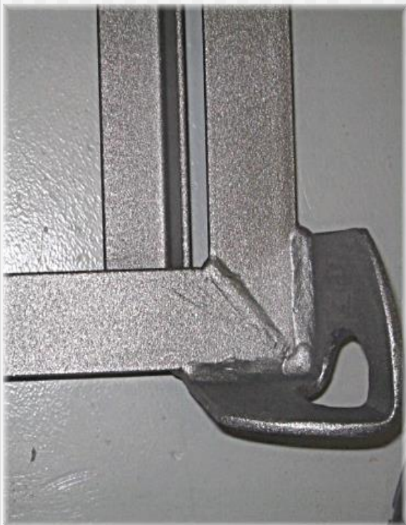
Kuva 3. Pinta puhdistettuna asteeseen Sa 3.
