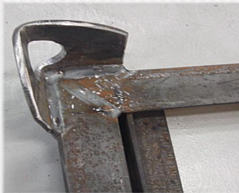
Kuva 2. Pinnan kunto on heikko. Se on puhdistettava kunnolla. Muutoin jauhemaalauksesta ei tule kestävä.
