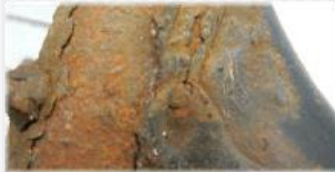
Kuva 2. Pinnassa on paksua rasvaista likaa, irtoavaa maalia ja pitkälle edennyttä ruostumista.
