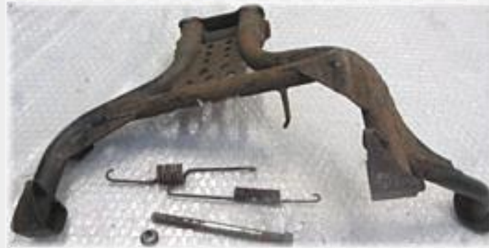
Kuva 2. Pinnassa on paksua rasvaista likaa, irtoavaa maalia ja pitkälle edennyttä ruostumista.
